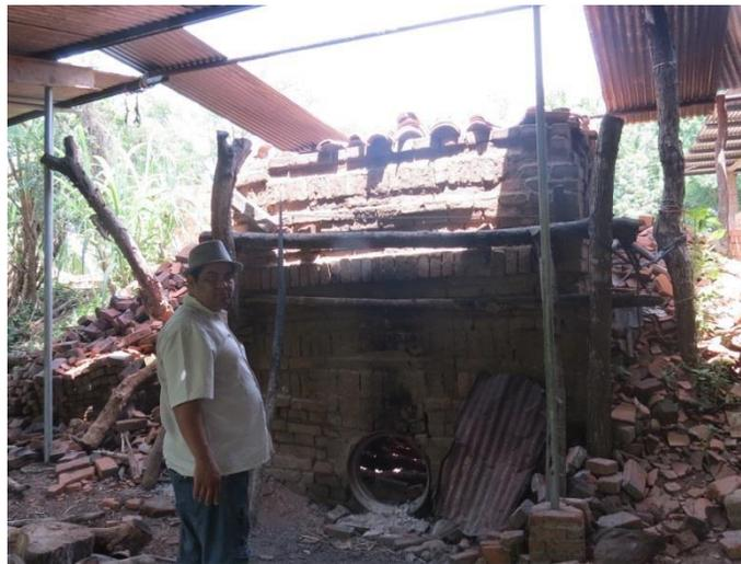
**Ilustración 8. Horno para cocer Ladrillos y tejas. Foto tomada en Fábrica de Ladrillos en El Limón de Chupampa, Herrera, Arq. Aguilar.**
