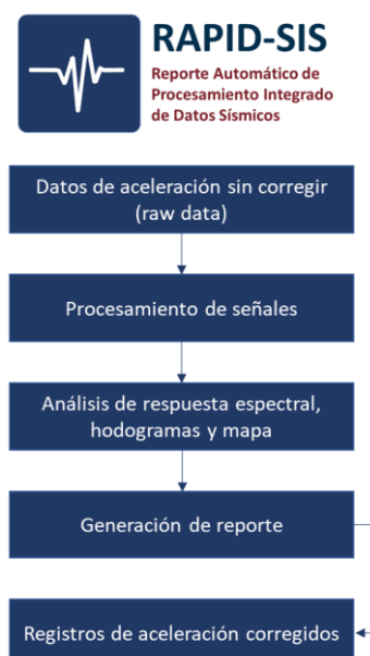
Figura 1. Esquema general del flujo de procesamiento en RAPID-SIS.
