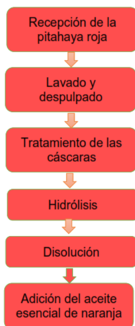
Figura 2. Diagrama de flujo del proceso de elaboración del recubrimiento
